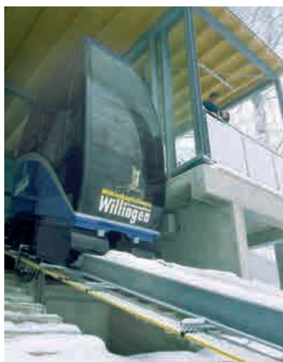
Toujours plus haut grâce à nous ! SinglePowerLine 0812 installé sur une cabine de remontée d'un tremplin de saut à ski
